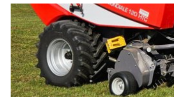
Spezialbereifung 22,5" mit Aussenbreite 2,52 m
