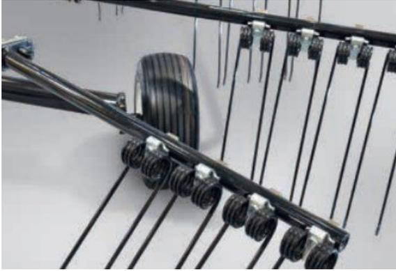
**Tangentiale Zinkenarmbefestigung** Die Zinkenarme werden nicht in der herkömmlichen 90°-Konfiguration montiert, sondern tangential angeordnet, um eine optimale Förderung und schonende Behandlung des Futterguts zu gewährleisten.
