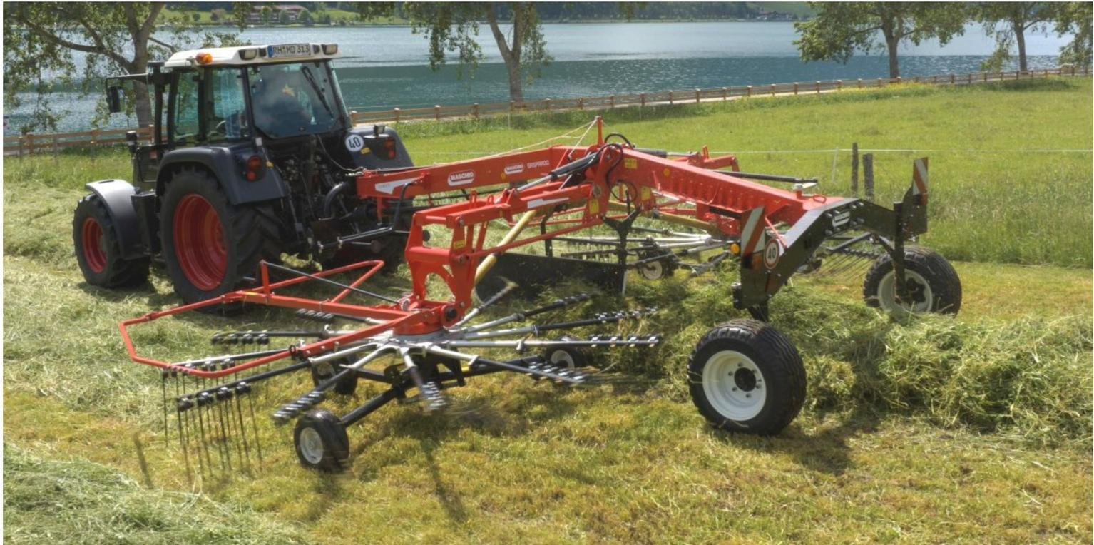
Die Ponente Einkreiselschwader ermöglichen eine seitliche Gutablage und sind mit einem verstellbaren Schwadttuch ausgestattet, das sich an die jeweilige Schwadbreite anpassen lässt. Es kann zwischen folgenden Radoptionen gewählt werden:
