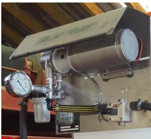
Dosieranlage sind auf einer Edelstahlplatte montiert und erhältlich mit: **Junior SP mit Membranpumpe, Junior SP - G mit Zahnradpumpe, Comfort-Profi mit Zahnradpumpe**
