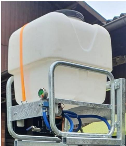
Diese Eco Sprayeranlagen bestehen aus einem propionsäurebeständigen Kunststofftank. Flüssigkeitsentnahme unten mit Dreiweghahn mit Anschluss für Behälterentleerung. Einstellbar, stufenlos über Bedienung. Mengenkontrolle über Manometer. Halterungsrahmen in verzinkter Ausführung.
