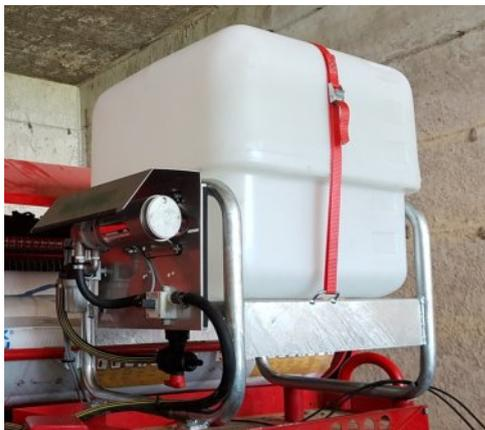
Diese Sprayeranlagen Comfort bestehen aus einem propionsäurebeständigen Kunststofftank.
