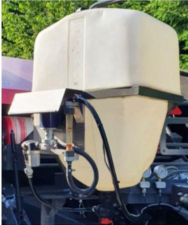
Diese Sprayeranlagen Basic hoch Comfort bestehen aus einem Propionsäure beständigen Kunststofftank.
